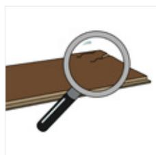
Les lames présentant des défauts ou des dommages ne doivent pas être installées. Veillez à mélanger des lames provenant de différentes boîtes afin d'obtenir un sol plus naturel. Les lames doivent être posés de manière flottante et ne doivent pas être vissés ni cloués au support.
