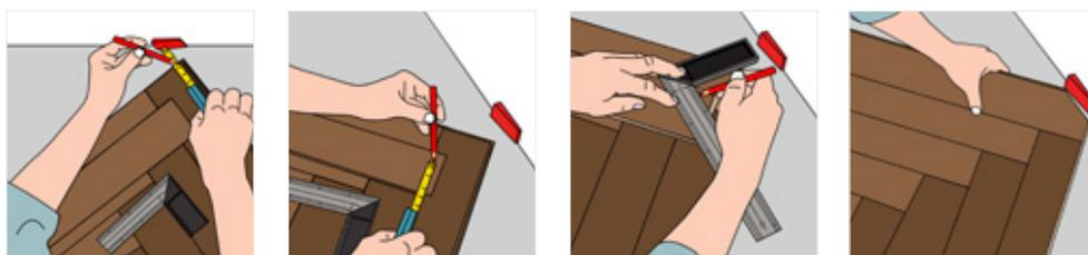
Lors de la pose des dernières lames, mesurez l'espace restant (X et Y). Assemblez un triangle de lames A et B et indiquez les dimensions de X et Y pour former une ligne de coupe.
