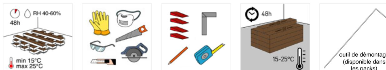
Il est nécessaire de stocker les boîtes à température ambiante pendant au moins 48 heures avant l'installation. N'ouvrez pas les paquets, mais veillez à les empiler de manière à ce qu'ils soient le plus possible en contact avec l'air.
