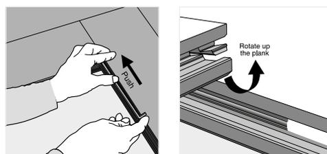
Lorsqu'une lame est verrouillée, il n'est pas possible de l'enlever simplement à la main. Utilisez l'outil de démontage 5G® pour démonter les lames. Insérez la clé dans le système de clipsage et poussez-la jusqu'à atteindre l'extrémité de la lame. Soulevez la lame, pour votre sécurité, utilisez des vêtements de protection : gants, masque anti-poussière, lunettes de protection.
