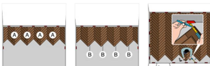
Mesurez la distance entre le mur et l'angle de la lame, où le motif se termine. Tenez compte du joint de dilatation de 8 mm.
