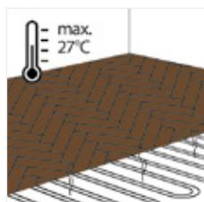
Le sol Zenn Rigid Click est compatible avec le chauffage au sol, à condition que la température à la surface du revêtement ne dépasse pas 27°C. En cas de chauffage électrique au sol, il est recommandé de ne pas dépasser 60W/m<sup>2</sup>. Rappelez-vous que les joints de dilatation entre les cercles chauffants séparés dans le support doivent être reportés par le revêtement de sol.
