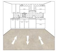
Für die meisten großformatigen Designs sollten die Platten abwechselnd in entgegengesetzter Richtung verlegt werden. Lesen Sie vor dem Beginn der Verlegearbeiten die Designspezifikationen.
